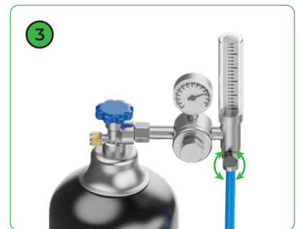
(3) 가스 유량을 15L/min - 30L/min으로 조정합니다.
